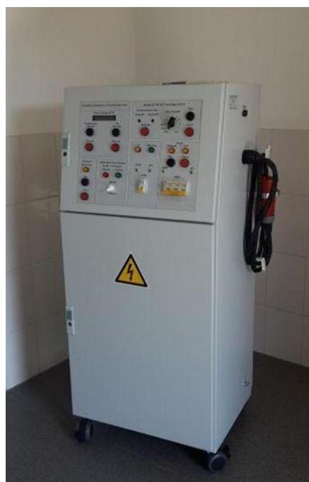
\*КГРС обеспечивает гальваническую развязку выходного напряжения от питающей сети.
