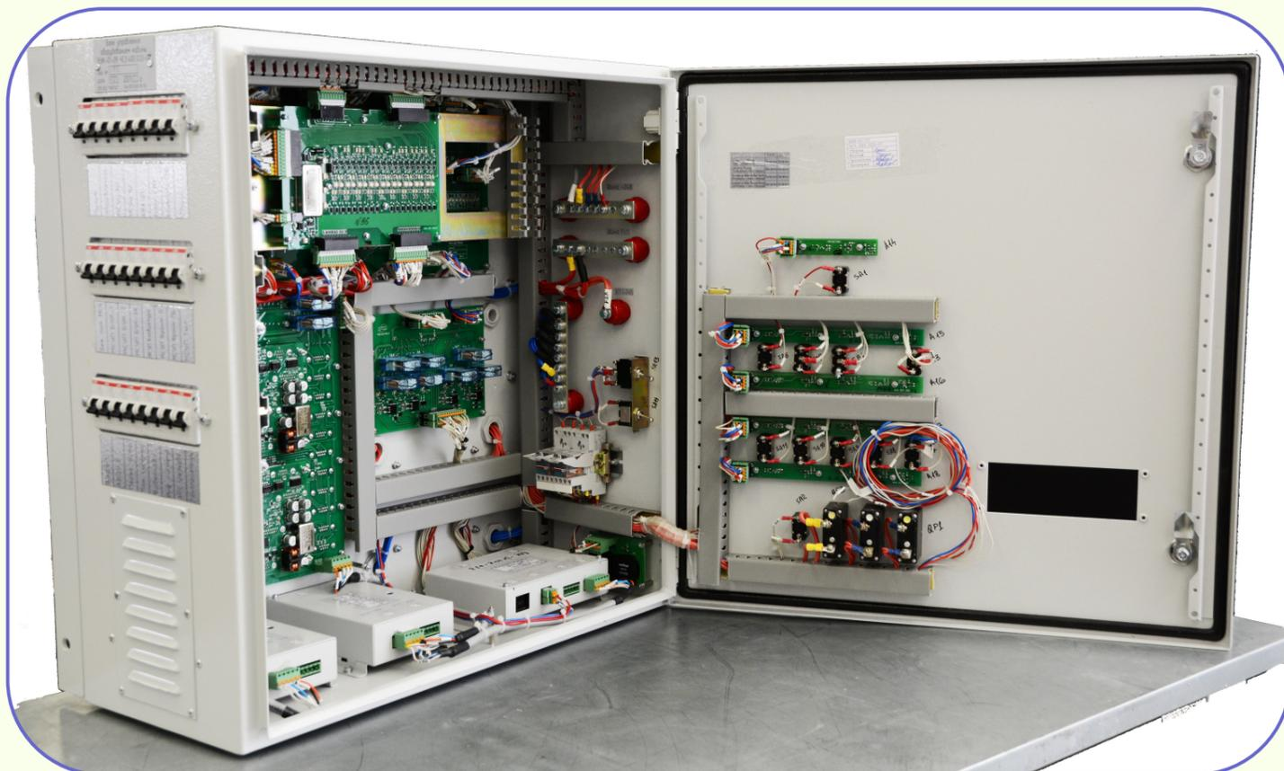
**Блок управления оборудованием кабины БУК-01** - центральное коммуникационное устройство управления трамвайным вагоном. Обеспечивает низковольтное питание устройств вагона, принимает сигналы от органов управления и передает их тяговым преобразователям, механическим тормозам и другим блокам по проводам и цифровым линиям связи.
