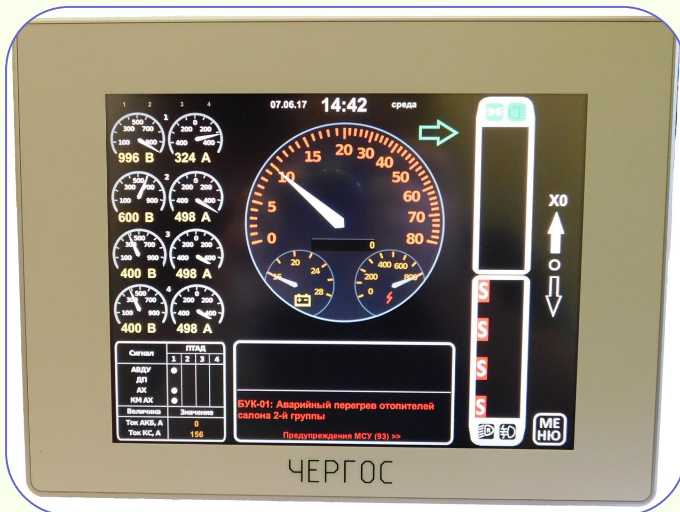
**Блок индикации графический БИГ-10** - цветной сенсорный монитор диагональю 10" - отображает информацию о состоянии тягового электропривода, скорости движения вагона, записывает параметры работы в «черный ящик». Предоставляет интерфейс для тестирования тягового и бортового оборудования.
