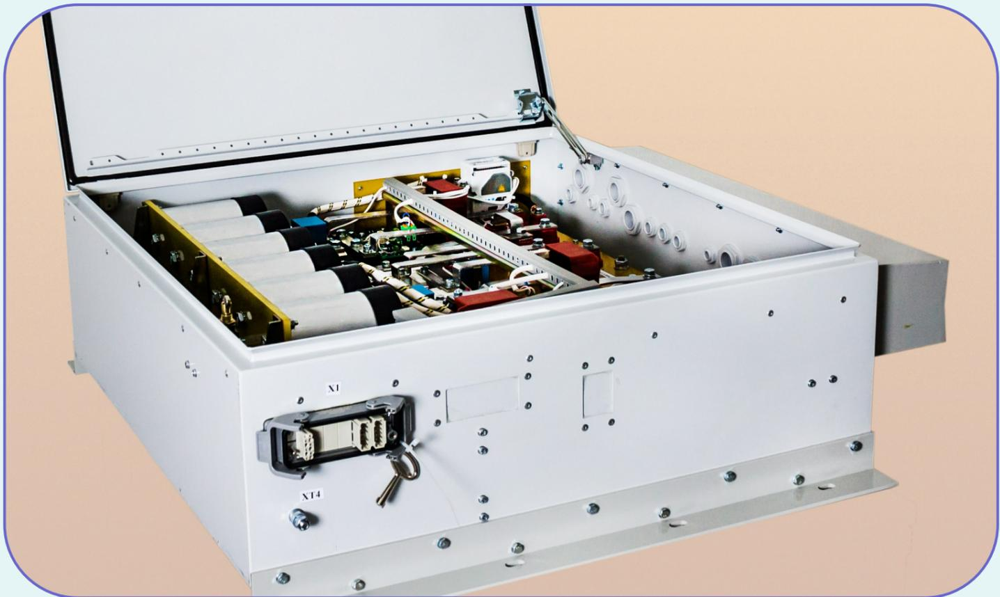
**КриЗВ** — конвертор заряда и разряда тяговой батареи с выпрямителем. Его задача выпрямление, сглаживание внешнего напряжения  $\sim 3 \times 380 \text{ В}$ , 50 Гц, контроль напряжения и тока заряда тяговой аккумуляторной батареи, отключение высоковольтных цепей тяговых преобразователей и цепей собственных нужд от тяговой аккумуляторной батареи в режиме её заряда.
