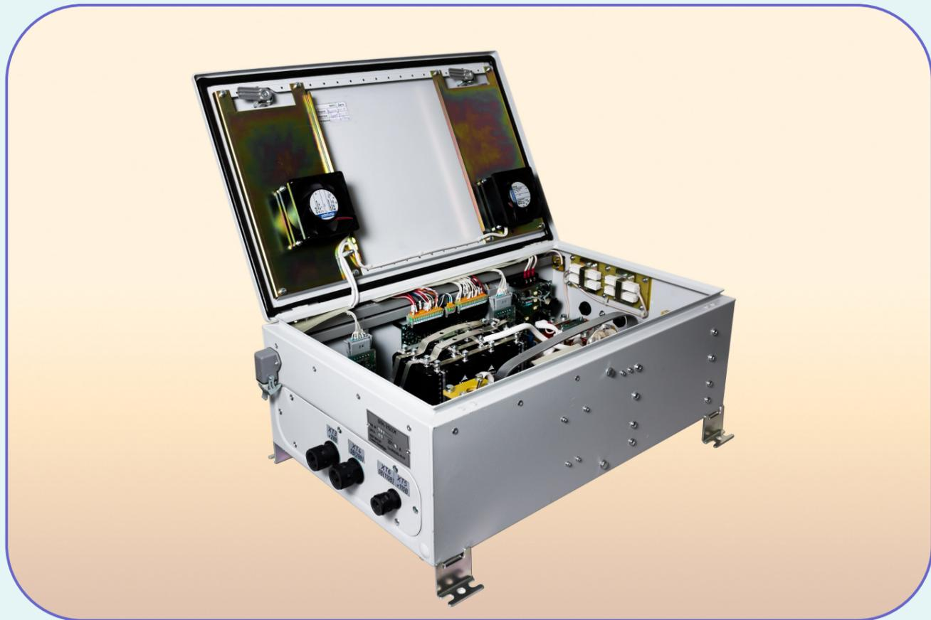
**БПН-215ТСМ** — вспомогательный DC/DC преобразователь, обеспечивающий гальванически изолированное питание бортовой сети электробуса и подзаряд аккумуляторной батареи. Выходные параметры - 28 В, 220 А. Содержит встроенный источник 110 В для обогрева лобового стекла. Не требует бортового питания для запуска.
