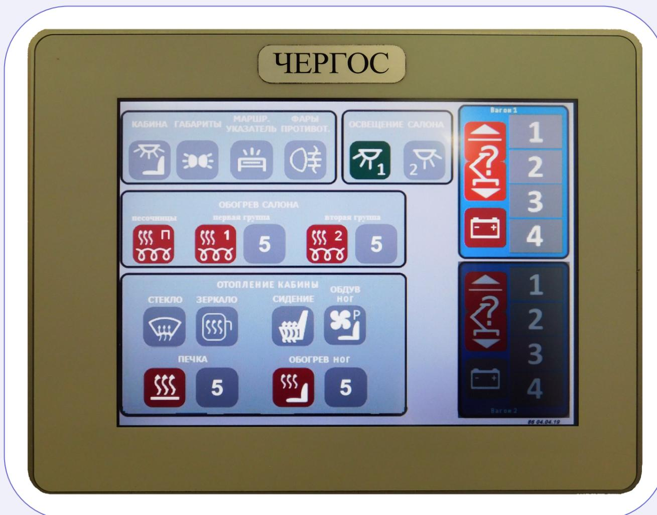
Блок индикации графический БИГ-05 имеет сенсорный экран, отображает информацию, передаваемую от комплекта тягового оборудования:
