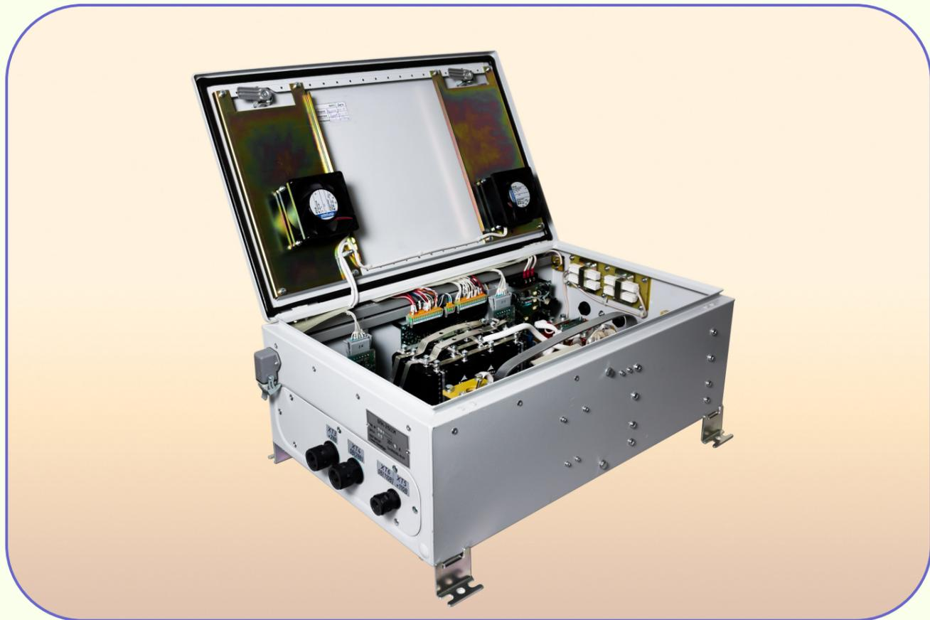
**Преобразователь напряжения БПН-215ССМ** - питающий DC/DC преобразователь, с гальванической развязкой от контактной сети, питает устройства бортовой сети трамвайного вагона напряжением 28 В, заряжает аккумуляторную батарею. Выходные параметры - 28 В, 220 А. Содержит встроенный источник 110 В для обогрева лобового стекла. Запускается в работу от высоковольтного напряжения.
