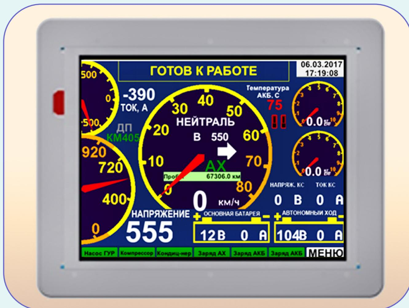
**БИГ-05** — блок индикации графический отображает информацию о состоянии тяговой батареи, текущего заряда, расхода энергии на 100 км, состоянии контакторов батареи, информацию о состоянии тягового электропривода и скорости движения электробуса.
