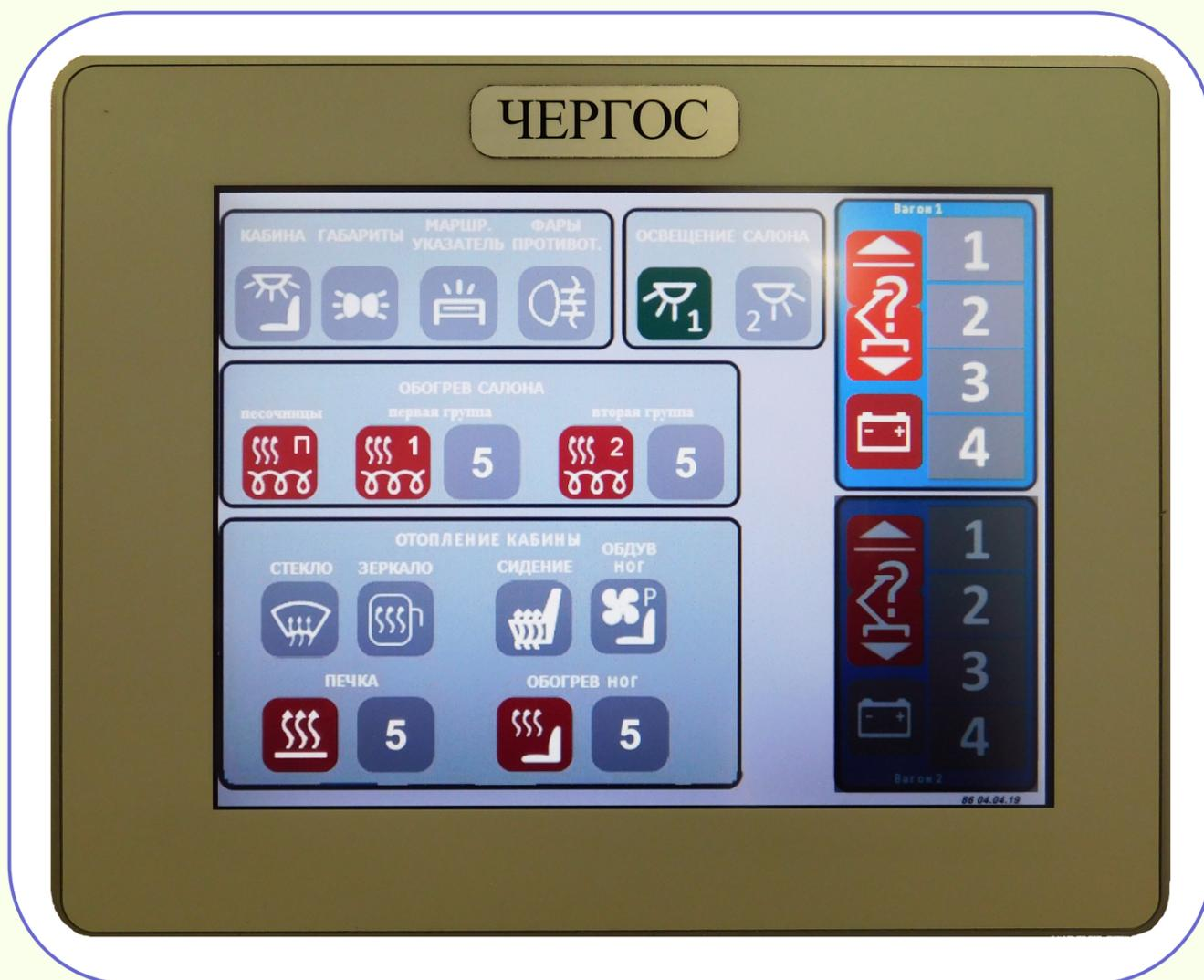
**Блок индикации графический БИГ-05** - цветной сенсорный монитор диагональю 8,4" - отображает интерфейс управления бортовым оборудованием трамвайного вагона. (в частности, состояние и режимы отопления)
