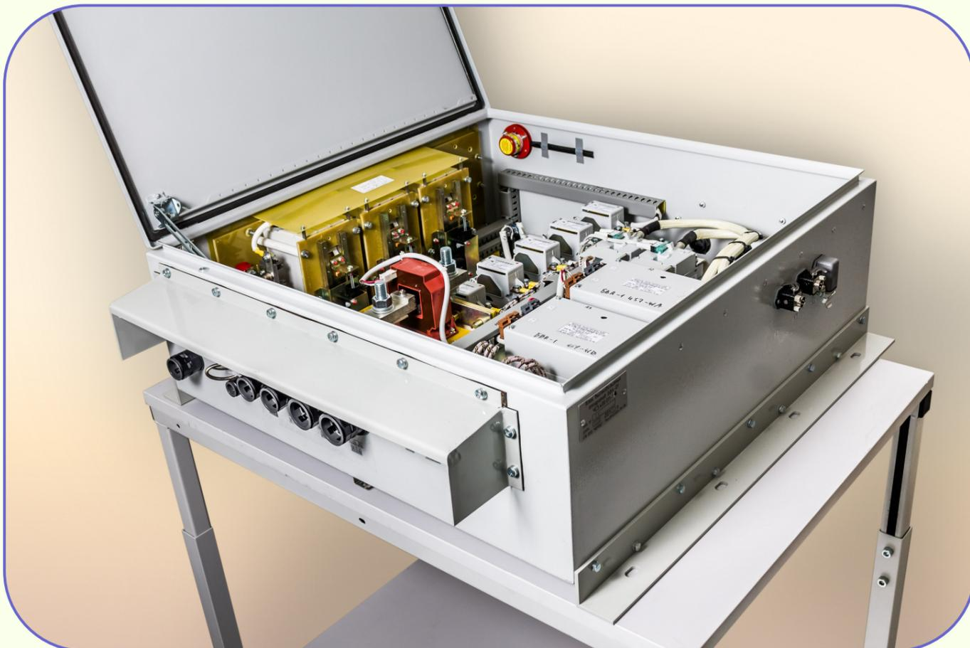
**Блок высоковольтных аппаратов БВА-01** - коммутационное устройство, выполняет распределение и защиту высоковольтного питания оборудования (тяговые и вспомогательные преобразователи, калориферы отопления, 2-й вагон поезда).
