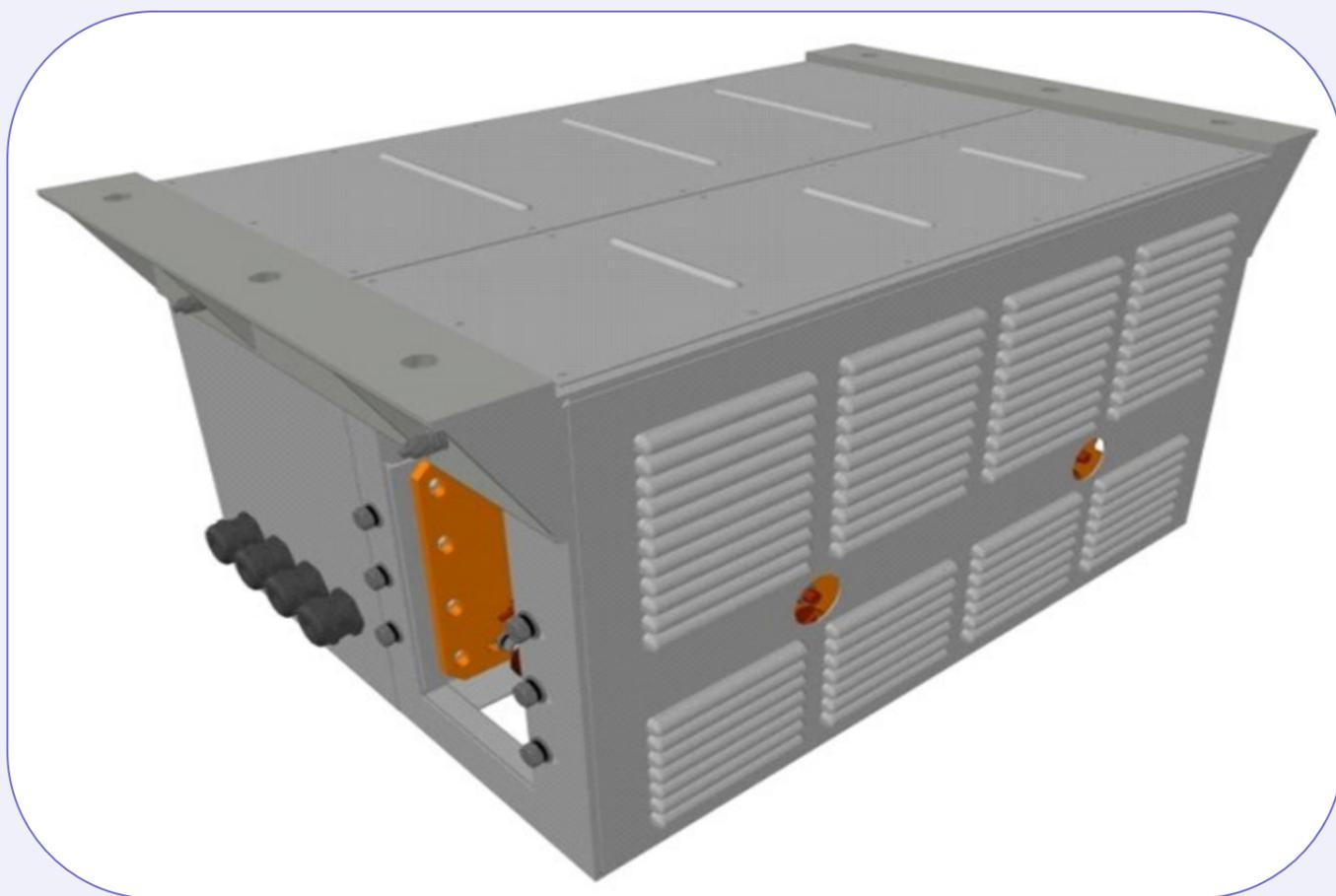
**Установка входного фильтра УВФ-21** – фильтрует напряжение контактной сети и пульсации тока тяговых инверторов, с 2020 года выпускается с активной компонентой фильтрации УФД-21А с подавление пульсаций тока в 5 раз относительно нормируемых уровне во всем частотном диапазоне, уменьшает дифференциальную индуктивность до 1 мГн.
