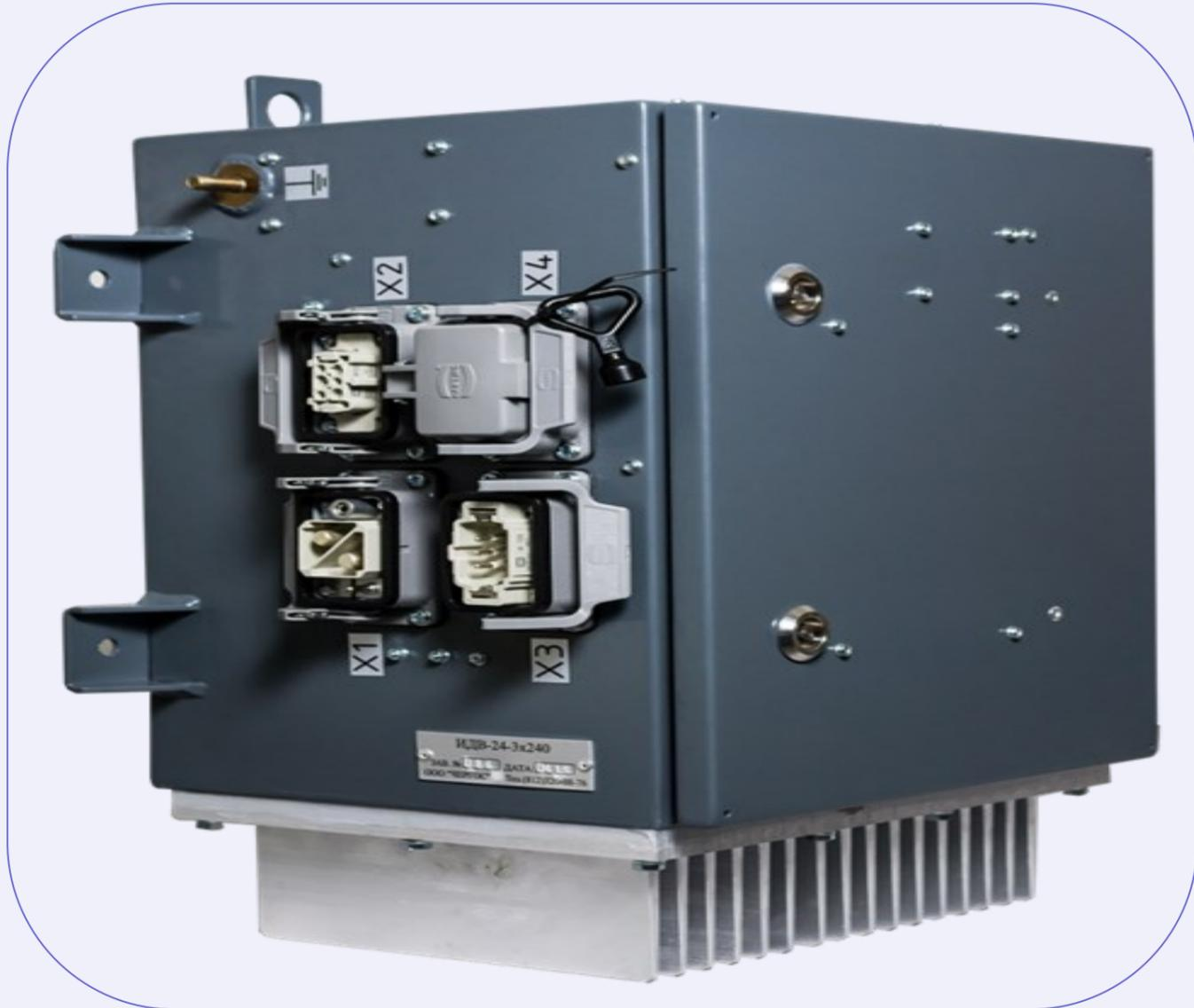
**Инвертор двигателя принудительной вентиляции ИДВ-24-3x240** преобразовывает напряжение бортовой сети постоянного тока 16,8...30,0 В в трехфазное напряжение переменного тока 240 В (линейное значение) мощностью до 5 кВА для питания асинхронных электродвигателей вентиляторов аварийной вентиляции вагона. Установлен на вагонах “НЕВА” (71-556/557/558) Петербургского метрополитена.
